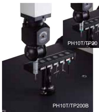
支持最大300mm延长杆的自动旋转测头。水平转角 $\pm 180^\circ$ ，垂直转角 $0 \sim +105^\circ$ ，以 $7.5^\circ$ 间距转动。使用TP200B时：最大测针长度100 mm (GF测针使用时)。最大延长杆支持200 mm。
