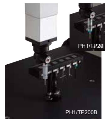
对应200mm延长杆。水平转角的间距为 $15^\circ$ ，垂直旋转可以任意角度转动。使用TP200B时：最大允许长度误差： $E_0$ ， $MPE(\mu m) 2.2 + L/250$
